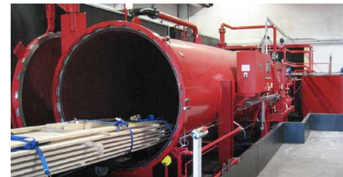
Druckimprägnierung von Holzpaneelen mit Wolmanit® Firestop
